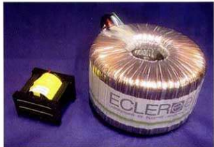
Das Bild zeigt einen kleinen HF-Transformator, ähnlich dem in der DT6800, und einen Ringkerntrafo. Dieser Ringkerntrafo ist für eine Nennleistung von 1500W ausgelegt, während der kleine HF-Trafo etwa die doppelte Leistung verarbeitet.
